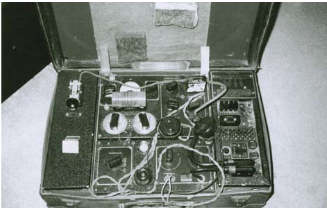
Radiotelegrafski aparat B Mark II ali B2
